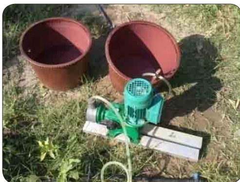
شکل ۶: پمپ مخصوص تزریق اسید قطره‌ای
