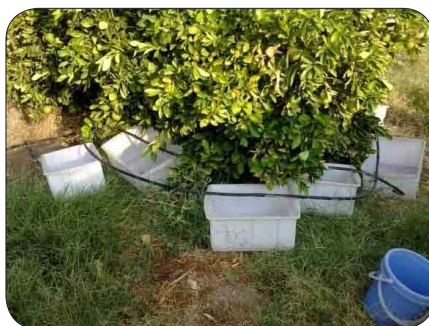
شکل ۸: نحوه کنترل طرز کار و میزان آب خروجی از قطره‌چکان‌ها
