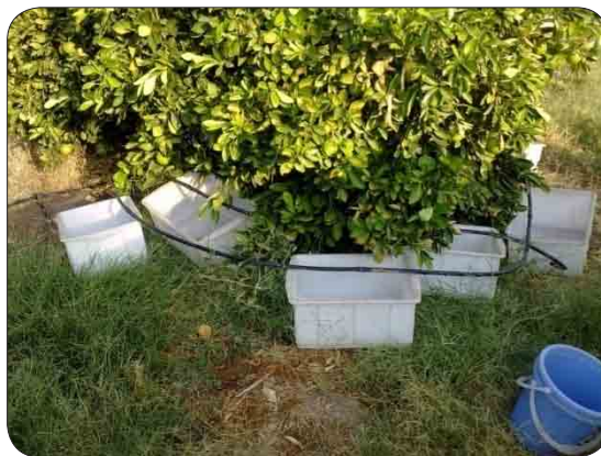
شکل ۳: نحوه اندازه‌گیری میزان دبی قطره چکان‌ها
